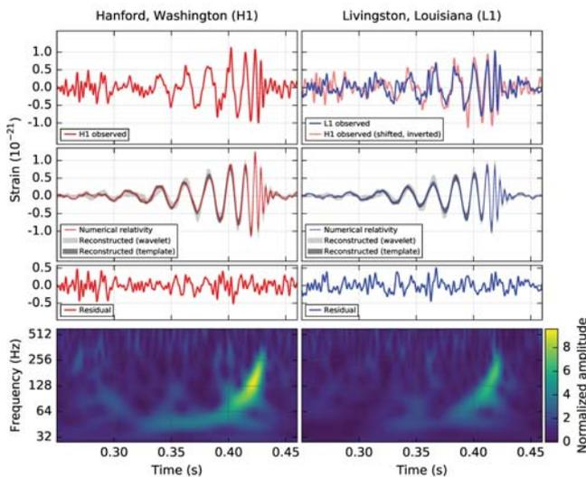
Signal gravitationnel (déformation) émis par la fusion de deux trous noirs (haut) comparé aux courbes théoriques attendues (milieu), et spectre du signal reçu (bas).
